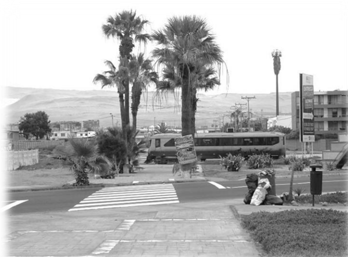
Foto 7: El autovagón N° 0261 del FCTA transita sobre un pasaje peatonal totalmente desprotegido, por no contar con barreras y ni siquiera señales de advertencia. (Foto: I Thomson)
